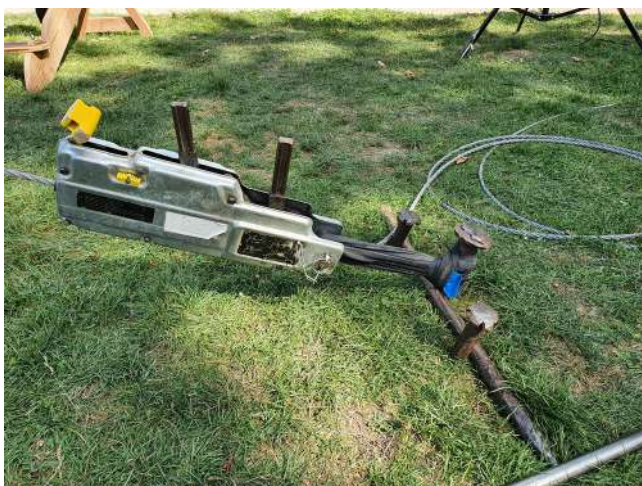
Accroche sur des pinces plantées dans le sol
